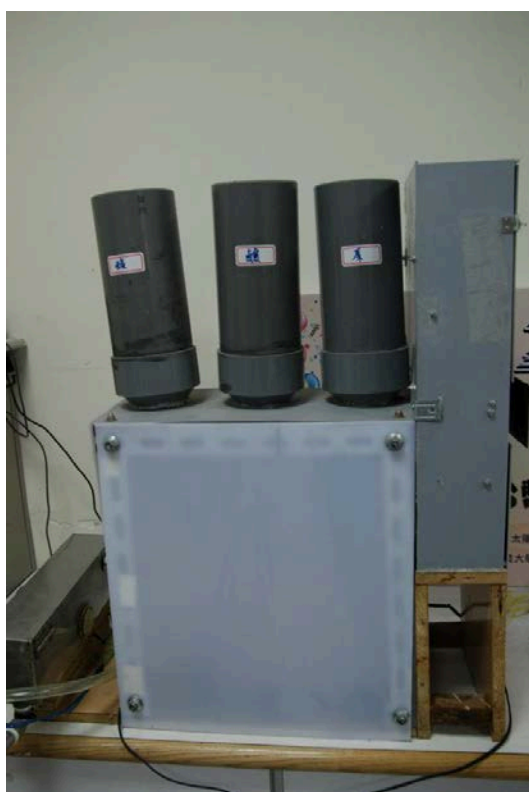
圖 4 自動超音波 RO 膜清洗系統
